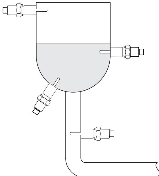
Der Sensor kann an jedem beliebigen Punkt des Behälters oder der Rohrleitung angebracht werden.
