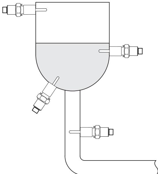
Le capteur peut être installé sur n'importe quel point du récipient ou de la canalisation.
