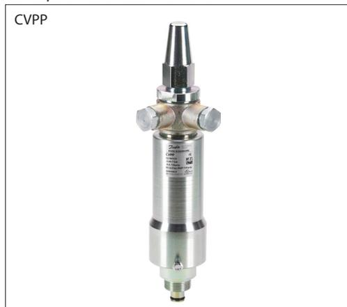
La vanne CVPP est une vanne pilote de pression différentielle conçue pour une pression max. de service (PMS) de 52 bar / 754 psi et avec 2 plages de réglage de pression comprises entre -0,66 et 28 bar (19,5 in. Hg à 406 psi).
