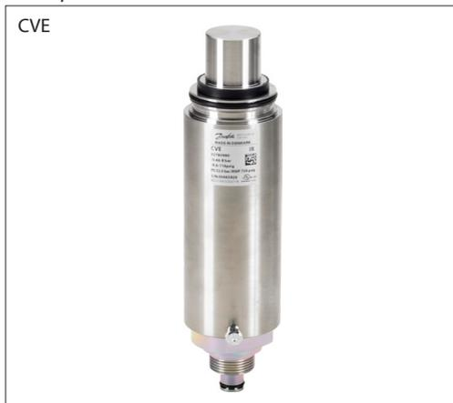
La vanne CVE est, lorsqu'elle est équipée du moteur pas à pas ICAD 1200A, une vanne pilote à pression constante avec modification du point de consigne électronique, conçue pour une pression max. de service (PMS) de 52 bar / 754 psi et une vaste plage de réglage de pression contrôlée de façon électronique et comprise entre -0,66 et 8 bar g (19,5 in. Hg à 116 psi). L'interface de la vanne CVE sur l'ICAD est hermétique et la rotation de l'ICAD est assurée par des forces magnétiques.
