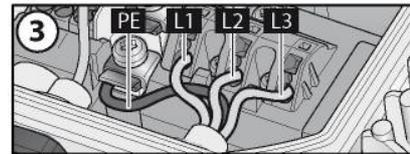
Illustr. 4: Raccordement des câbles sur les bornes
