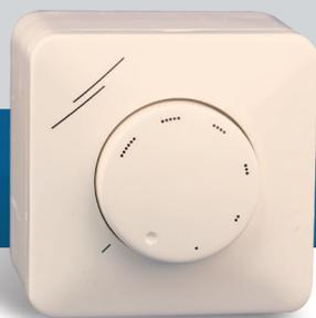
Les variateurs de vitesse MT fournissent le contrôle manuel de la vitesse des moteurs (230 VAC / 50 Hz) réglables par tension en faisant varier la tension par le contrôle de l'angle de phase. Ils sont appropriés pour montage encastré ou montage en saillie. Plusieurs moteurs peuvent être raccordés aussi longtemps que la limite de courant ne soit pas dépassée. Toutes les versions disposent d'une sortie supplémentaire 230 VAC (non-réglée).
