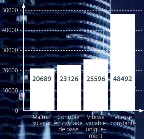
Le mode maître/suiveur peut réduire la consommation énergétique de moitié par rapport à la technologie traditionnelle de mise hors/sous tension des pompes/ventilateurs et de l'étranglement de la soupape.
