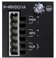
Abbildung 4: Power Supply (PWR/RPS)
